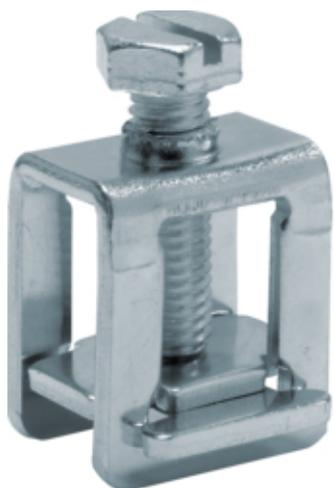
Borne de barre 16mm<sup>2</sup>-70mm<sup>2</sup> pour barres 12x5mm,
