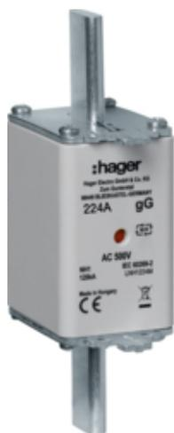
**NH-Sicherungseinsatz NH1 gG 500V 224A Kombi-Melder Griffflasche spannungsführend**
