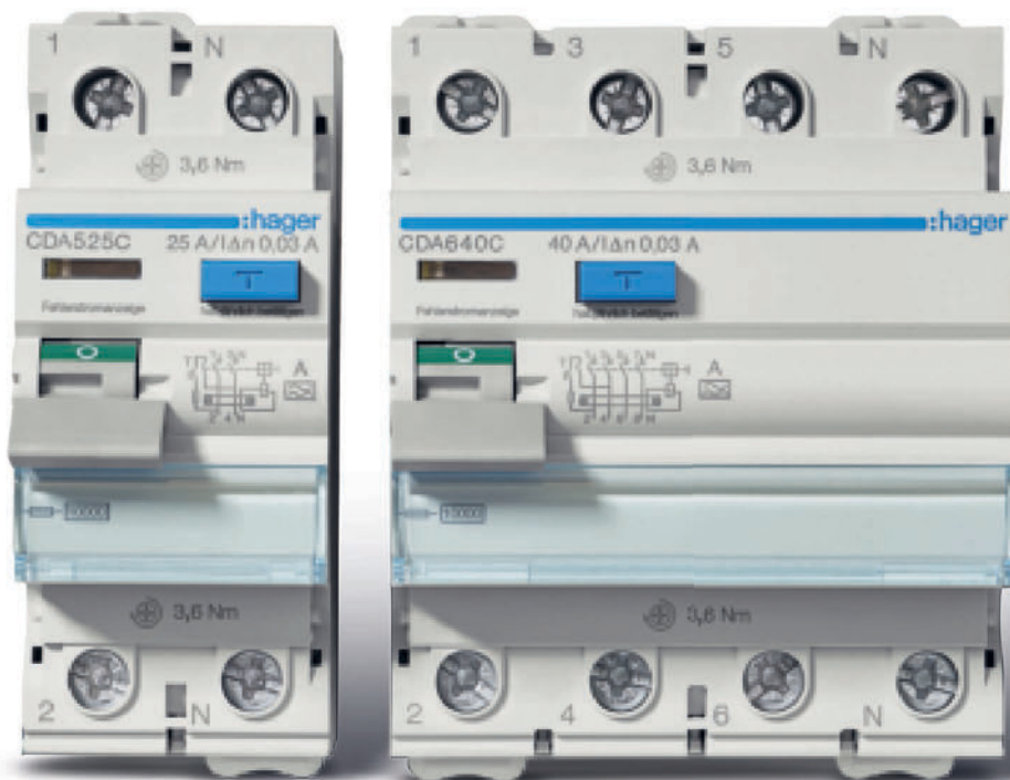
FI-Schutzschalter 1P+N 10 kA 25 A 30 mA Typ A, CDA525C
