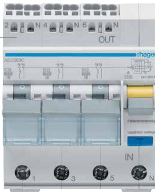
Interrupteur différentiel tétrapolaire (3P+N) intégré avec indicateur de déclenchement jaune. Protection différentielle pour l'ensemble du groupe (3x 1P+N).
