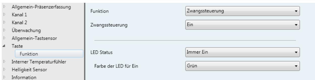
Bild 24: Funktion „Zwangssteuerung“
