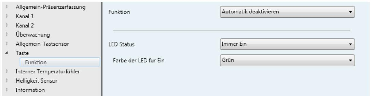
Bild 33: Parameter „Automatikfunktionen deaktivieren“
