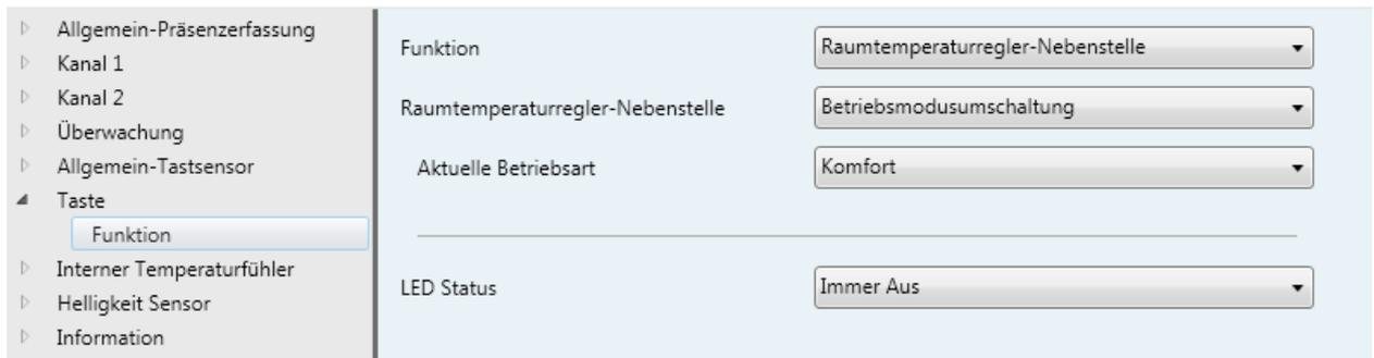
Bild 23: Funktion der Taste „Raumtemperaturregler-Nebenstelle“
