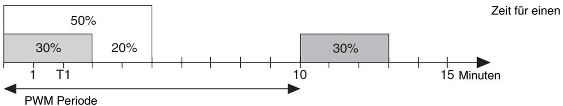
Ist zum Zeitpunkt des Empfangs der neuen Stellgröße die neue Einschaltzeit schon überschritten, so wird der Ausgang sofort ausgeschaltet.
