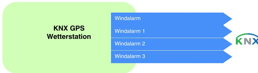
Der Windgeschwindigkeitswert wird zyklisch alle 30 Minuten und bei jeder Veränderung gesendet, bei der die Abweichung von der letzten Messung größer als 20% ist.
