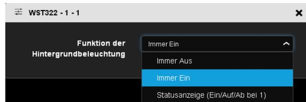
Um mithilfe der Information Tag/Nacht die LEDs der Taster zu steuern, muss die Status-LED-Funktion in Bezug auf das Produkt parametrieren werden.
