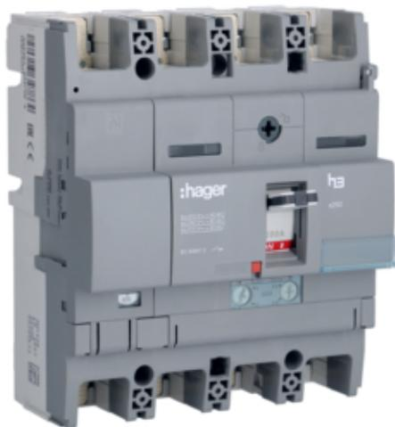
Disjoncteur boîtier moulé x250 4P 60% 40kA 200A TM
