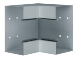
Inneneck aus Grundprofil zu BRS 100x170mm Oberteil 80mm aus Stahlblech verzinkt
