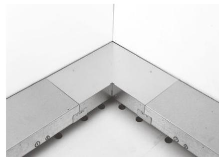
9. Vissage du couvercle de protection à l'aide des vis autotaraudeuses fournies avec le canal (dans l'emballage sous film plastique collé). Ces dernières sont vissées directement, sans perçage préalable, sur la surface d'appui de la base du canal à travers les orifices du couvercle de protection.
