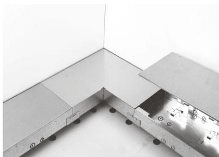
6. Fixation des canaux sur le sol brut à l'aide de vis de fixation. Recommandation minimale: 2 vis de fixation par mètre.
