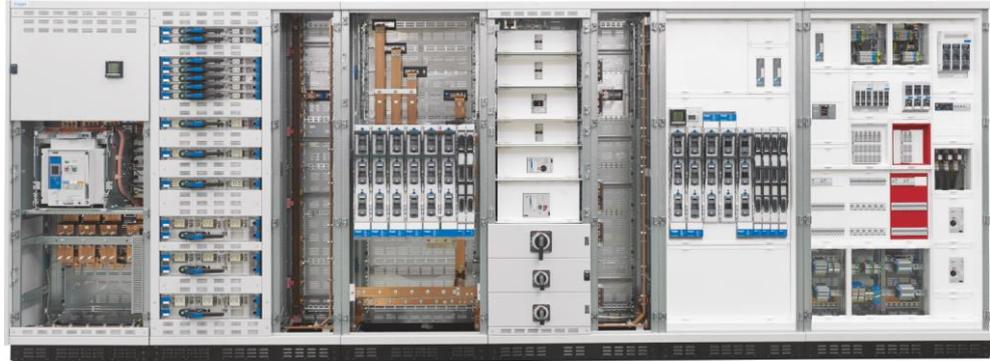
Sur la base de l'armoire U-BS(I), il est possible de réaliser plus de 1000 variantes différentes à partir de types d'armoires standardisés. Le raccordement au système de jeu de barres principal H-SaS avec liaison sans perçage permet de monter et de raccorder l'armoire très rapidement. Cette technique d'assemblage sans perçage permet aussi d'éviter les réductions de section transversale.
