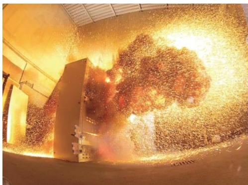
Arc électrique parasite provoqué en cas d'absence d'un dispositif de protection contre les arcs électriques parasites. L'apparition d'arcs électriques parasites peut occasionner des accidents mortels.
