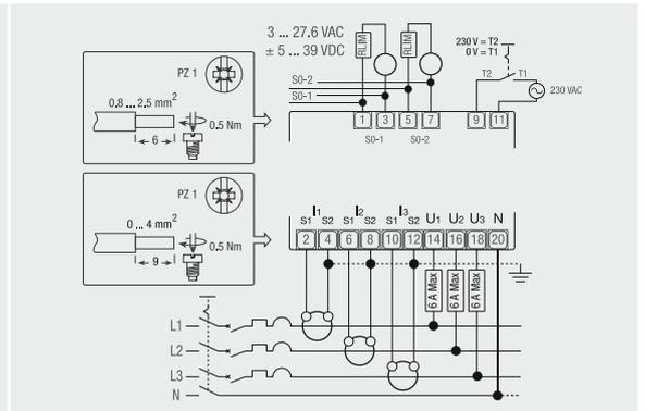
Mesure indirecte par transformateur jusqu'à 6000 A avec rapport de transformation secondaire 1 A ou 5 A
