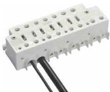
Universelle Zählersteckklemme für Querschnitte von 2,5 mm<sup>2</sup> bis 50 mm<sup>2</sup>. Einsatzbereich bis 100A Direktmessung
