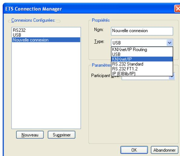
Créez une nouvelle interface et sélectionnez le type KNXnet/IP. L'ETS3 recherche automatiquement toutes les interfaces IP disponibles.
