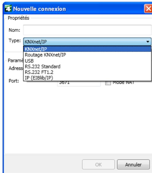
Créez une nouvelle interface et sélectionnez le type KNXnet/IP. L'ETS4 recherche automatiquement toutes les interfaces IP disponibles.
